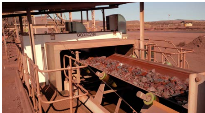
Geoscan, equipo de la marca SCANTECH (la cual es representada por FDA en Chile), utilizado para analizar materiales sobre correas transportadoras.
