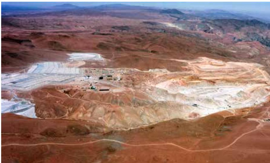
Quebrada Blanca es una operación a rajo abierto, la cual lixivia el mineral para producir cátodos de cobre a través del procesamiento en una planta de SX-EW. El cátodo de cobre se transporta en camión hasta Iquique para su envío a los compradores. El personal de la mina vive en una instalación de campamento y la mayoría de los trabajadores se trasladan desde ciudades como; Iquique, Arica y Santiago.
