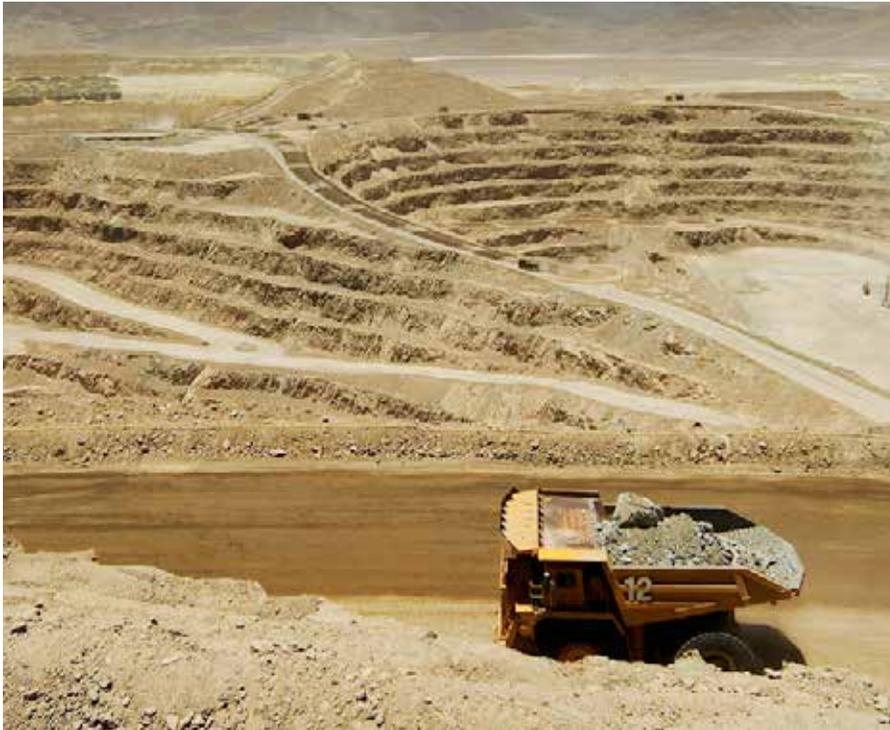
Compañía Minera Lomas Bayas, pertenece al grupo Glencore y es una empresa que produce cátodos de cobre a partir de la explotación de minerales de baja ley. La compañía explota a cielo abierto un yacimiento de cobre porfídico operando con procesos de lixiviación, extracción por solventes y electro-obtención (SX-EW).
